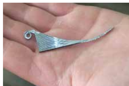
A kettős T profilok üregeinek kialakításakor ék alakú sorja képződik, amely eddig sok maró „életét nehezítette meg”. A Blaxx F5141 jelzésű marókat viszont ez nem befolyásolta
